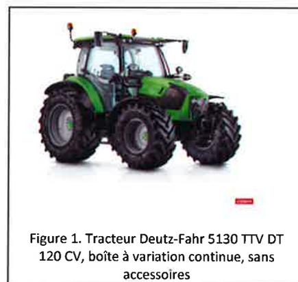
Figure 1. Tracteur Deutz-Fahr 5130 TTV DT 120 CV, boîte à variation continue, sans accessoires
